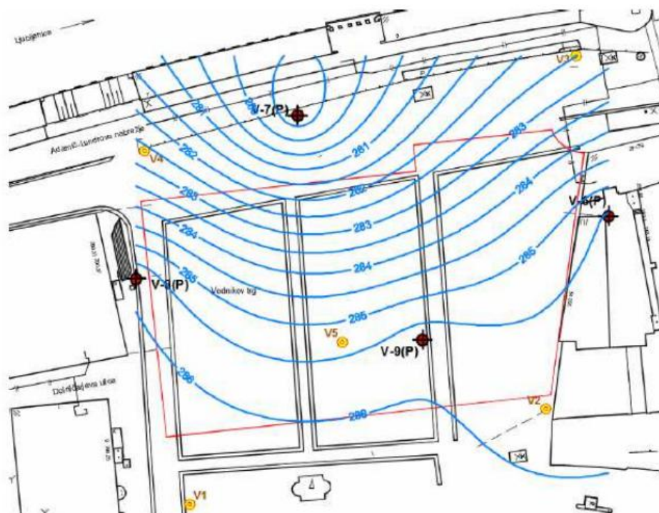
Slika 28: Karta piezometričnih nivojev podzemne vode na dan 9. 11. 2012 – visoko stanje
