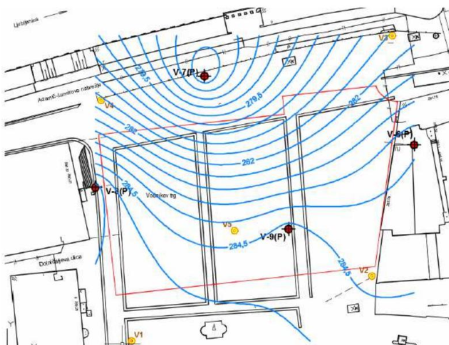
Slika 29: Karta piezometričnih nivojev podzemne vode na dan 20. 10. 2009 – nizko stanje
