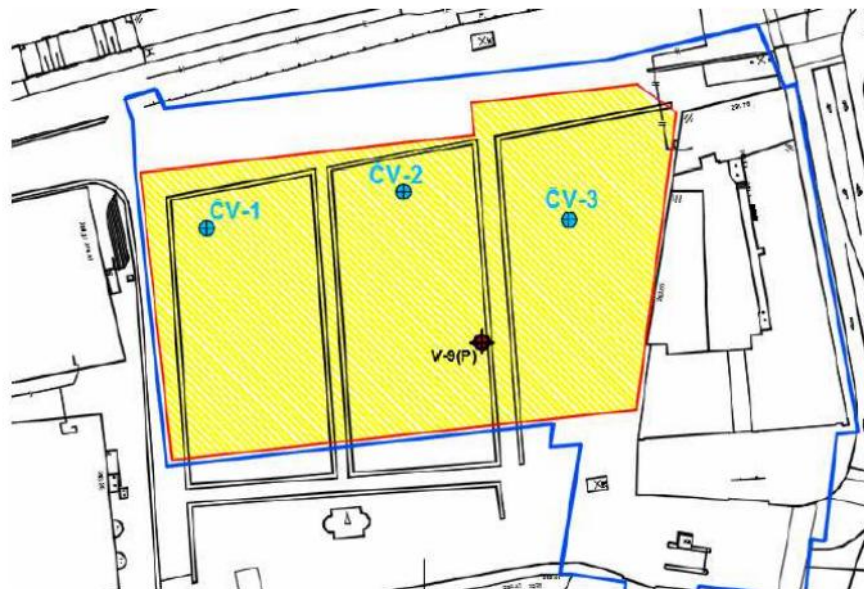
Slika 30: Okvirne lokacije črpalnih vodnjakov premera 100 mm
