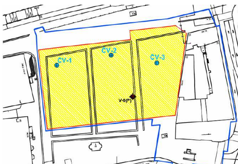
Slika 30: Okvirne lokacije črpalnih vodnjakov premera 100 mm
