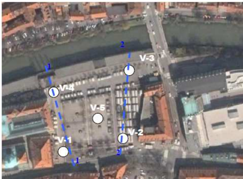
Slika 16: Lokacije vrtin za geotehnične raziskave na območju posega (vir: /13/)
