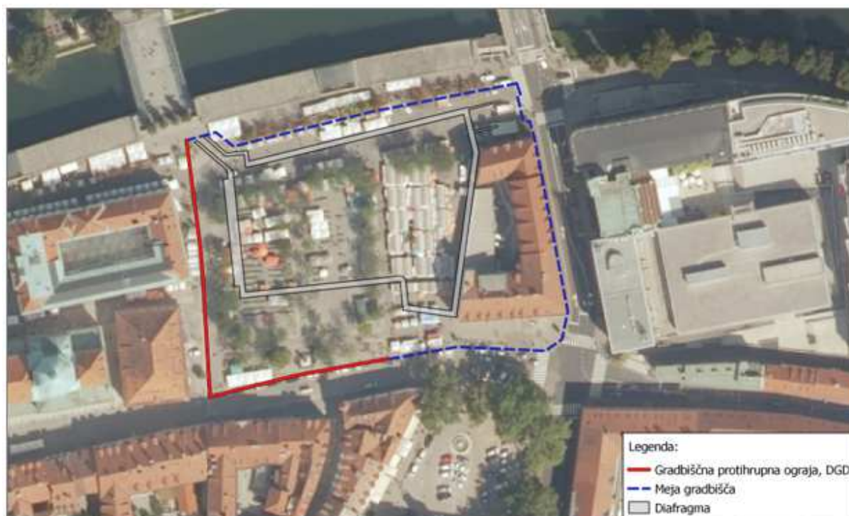
Slika 51: Lega predvidene gradbiščne protihrupne ograje, projekt DGD /1/
