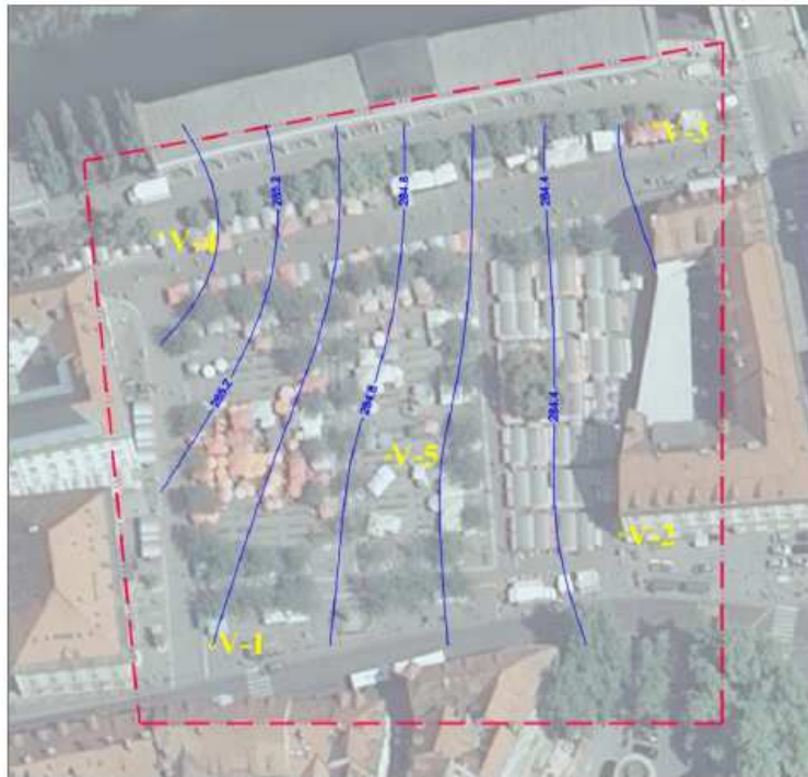
Slika 26: Gladina podzemne vode v območju nad glineno plastjo in rob hidrogeološkega modela (vir: /5/)
