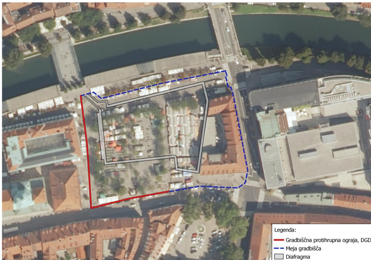
Slika 12: Lega predvidene gradbiščne protihrupne ograje, projekt DGD /1/
